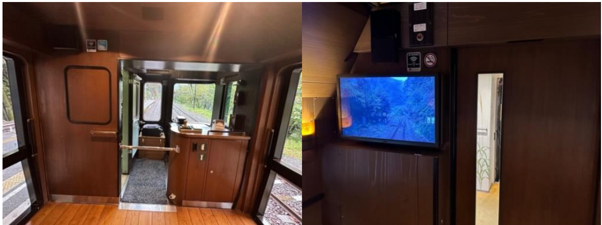
圖表 39.(左)車內駕駛端騎車側門採用大面積窗戶。(右)車廂內設置車前影像播放螢幕。
