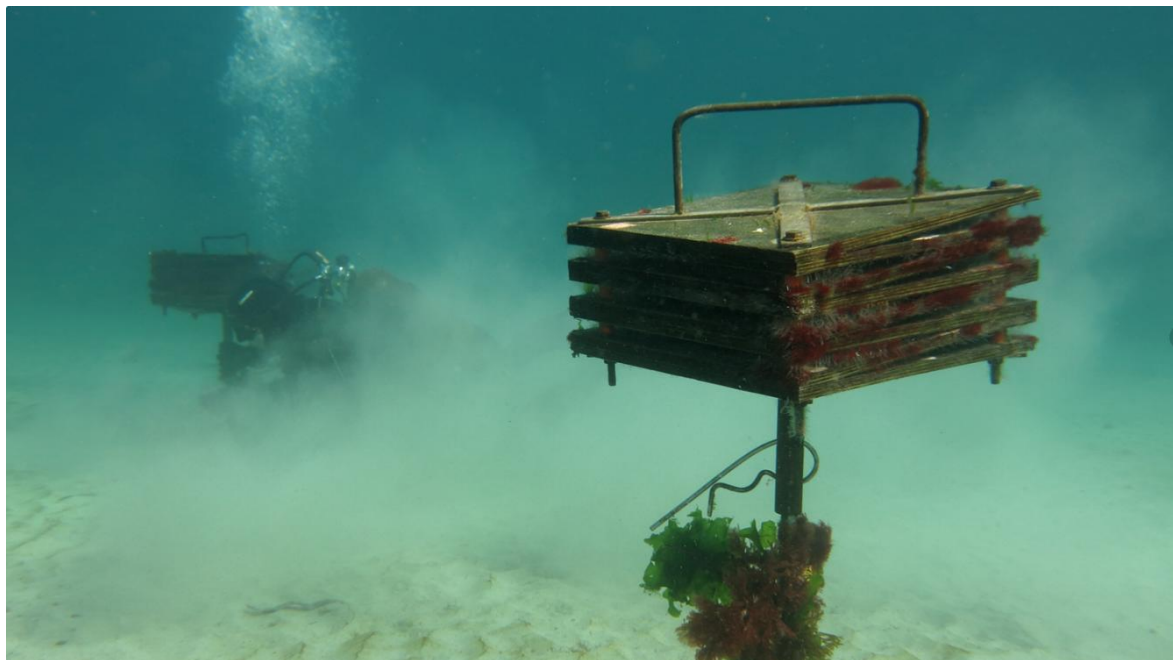
圖 16、IMAS 用以推估新荷蘭靜龍蝦 ( Jasus edwardsii ) 漂浮幼體沉降率與加入量的 puerulus collectors。
