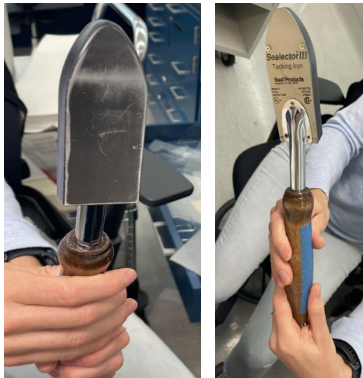
圖 3-25 熱熔膠紙修復時使用的熨斗 資料來源：自行拍攝
