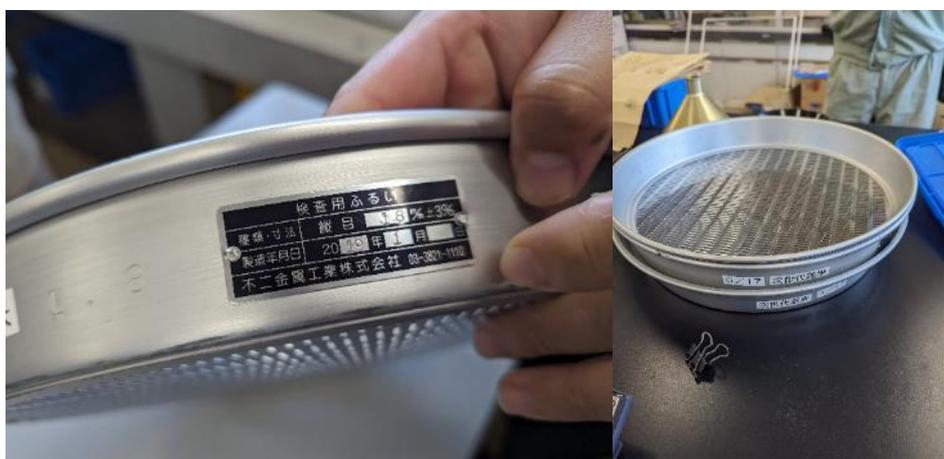
圖 4、食用米品系之糙米以 1.8-1.9mm 粒徑過篩、酒米品系之糙米以 2.0-2.05mm 篩網選別。
