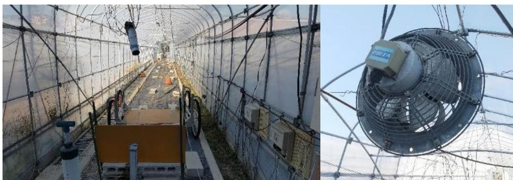
圖 1、塑膠布耐高溫溫室，上方設置風扇將熱風送至另一端，溫室中間設置溫度感測器。
