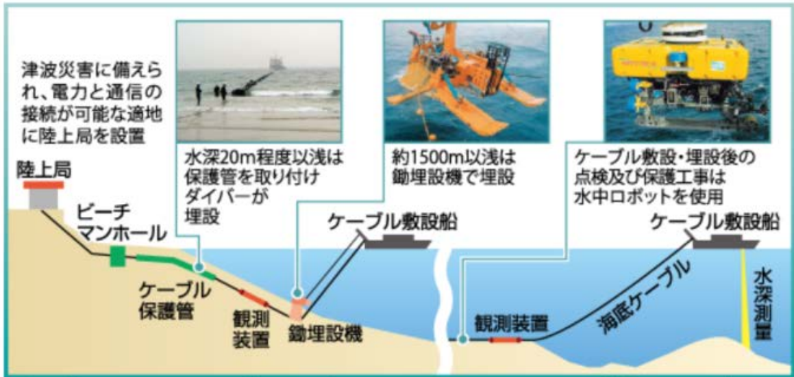
圖 2.1-6 在水深 1,500m 以下的漁區，會在海底挖 1m 左右深的海溝，並在其中安裝電纜和觀測設備。至於沿海和淺海地區的電纜則有特別保護管進行電纜之保護
