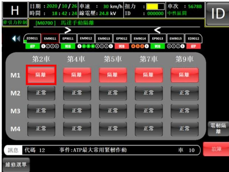
圖 2-14 牽引馬達隔離控制 TCMS 畫面
