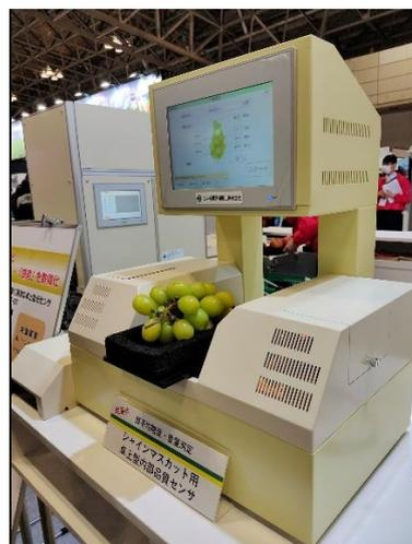
圖 1-9、透過光照波長判定水果甜度及重量分級測試機
