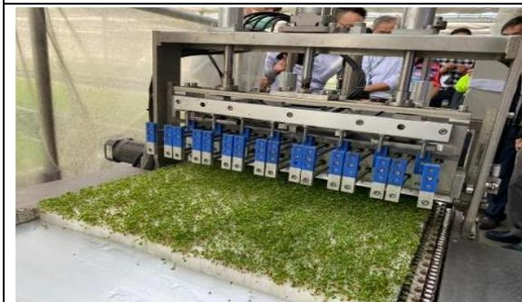
圖 6-3、自動化移植機
