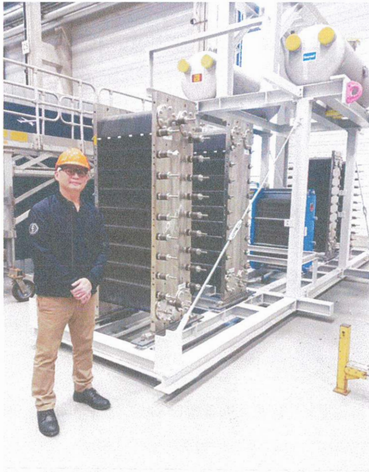
圖 12：製氫電解器模組實品(Silyzer 300)
