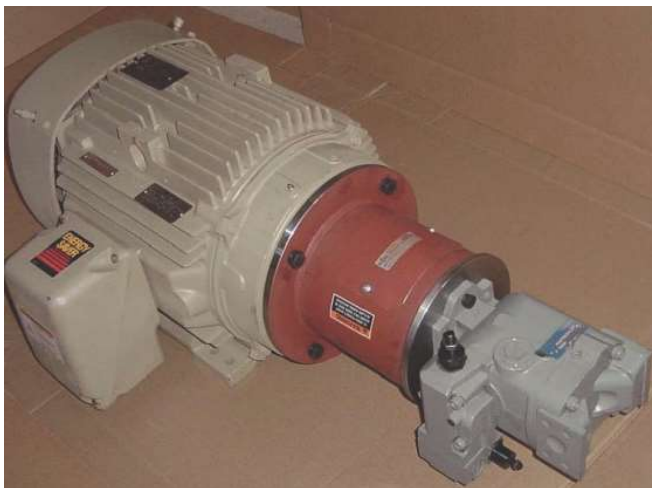
圖 11.11 頂升油泵示意圖
