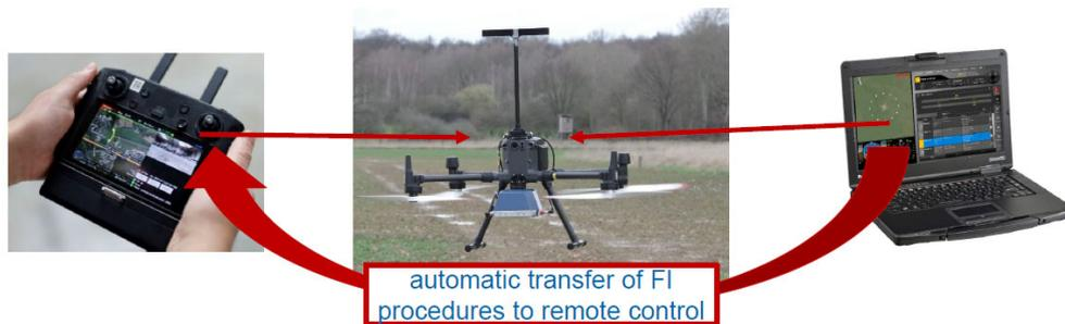
預計無人機不久的將來將能夠支援左右定位臺、滑降臺、測距儀、多向導航臺(VOR)、陸基增強系統(GBAS)的飛航測試工作，包括：
