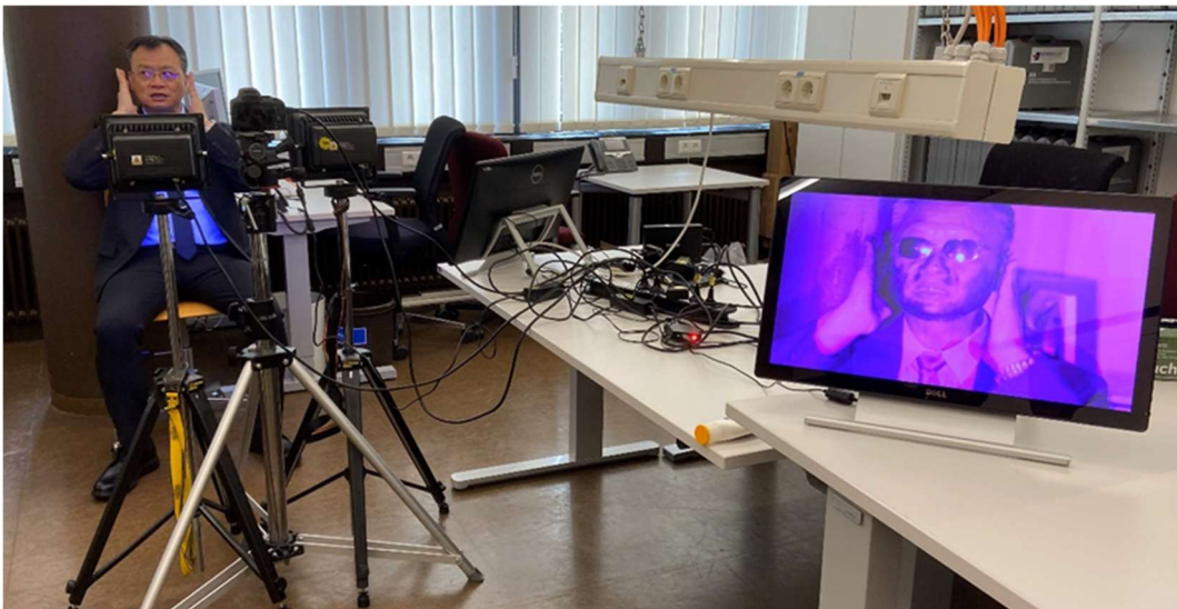
圖 11. 利用影像辨識技術顯示人員臉部之抗 UV 情形
