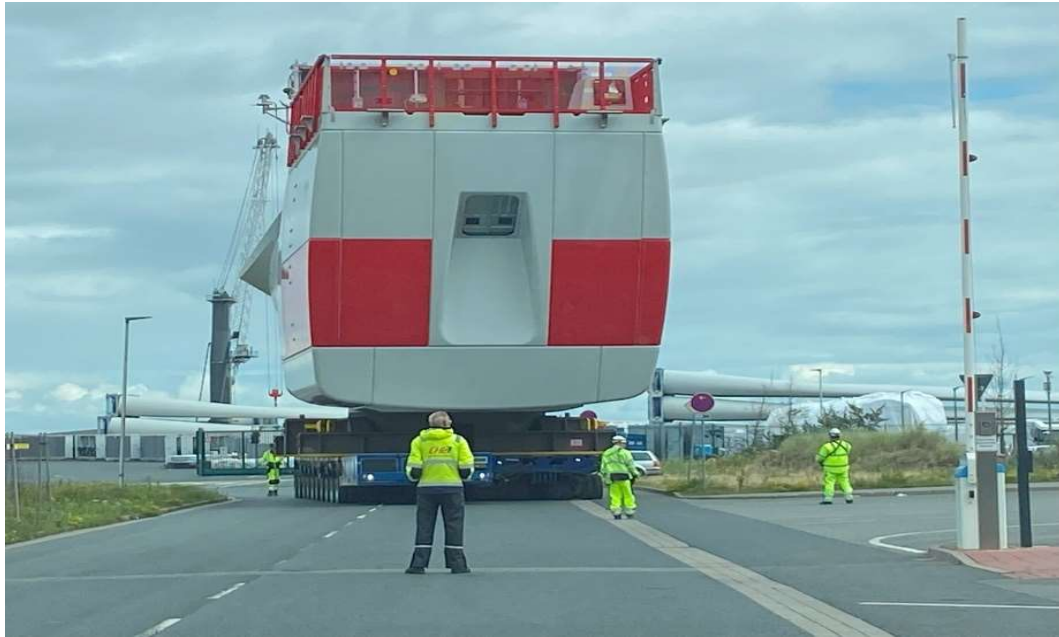
圖 29. 離岸風機機艙運輸過程
