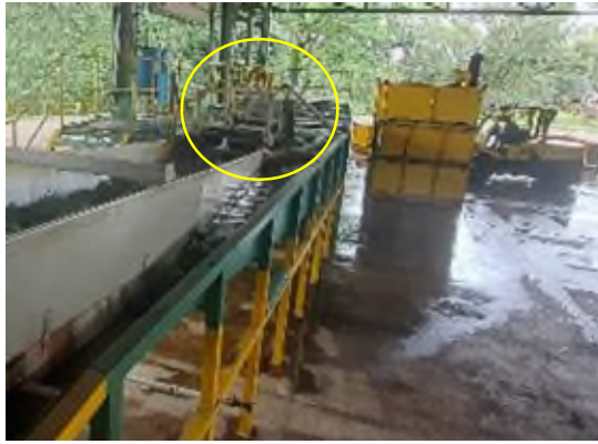
圖17、清潔池裝有果實自動向前撥動裝置
