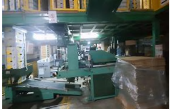
圖14、摺箱機在一樓向上輸送摺好紙箱
