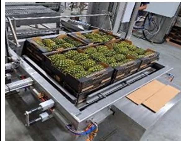
圖7、平臺式自動棧板打包設備
