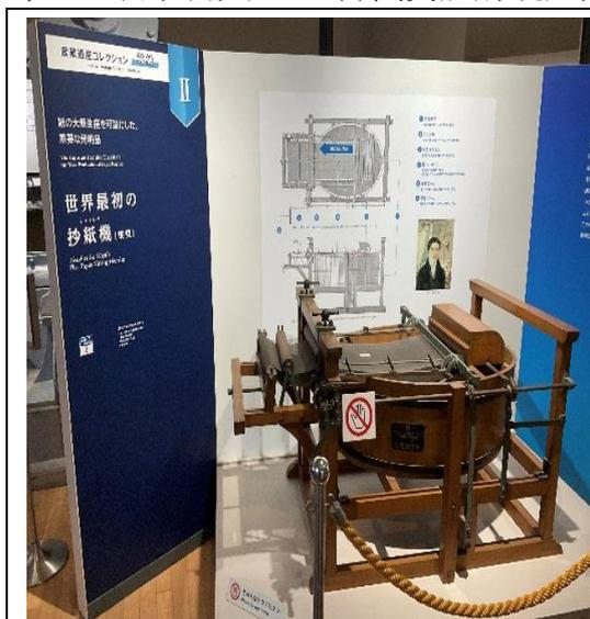
圖 53 世界最早的造紙機模型
