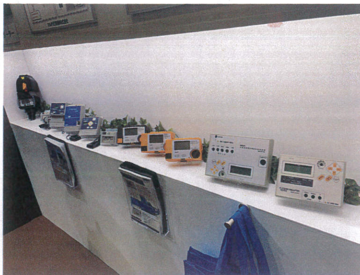
圖 10 太陽能專用絕緣阻抗計
