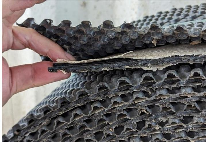
圖 31、MABR 卷式生物膜內部詳細構造
