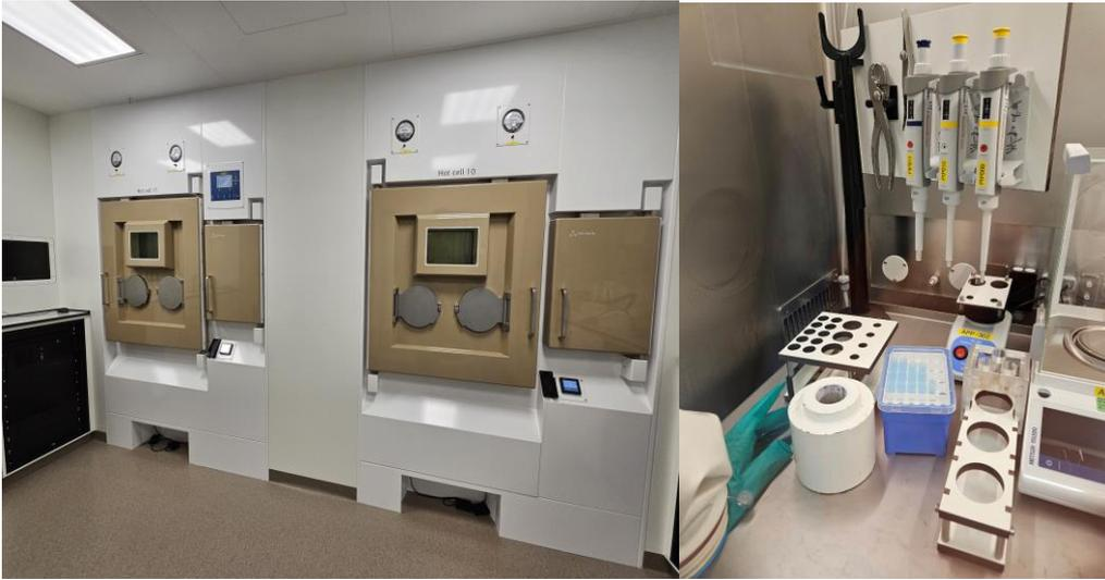
圖 14、熱室，在此進行鉛-89 標誌與純化步驟，手套箱中已放置所有必需儀器或器具，包含分注器、開瓶器、鉛罐、天枰及活度量測儀等。
