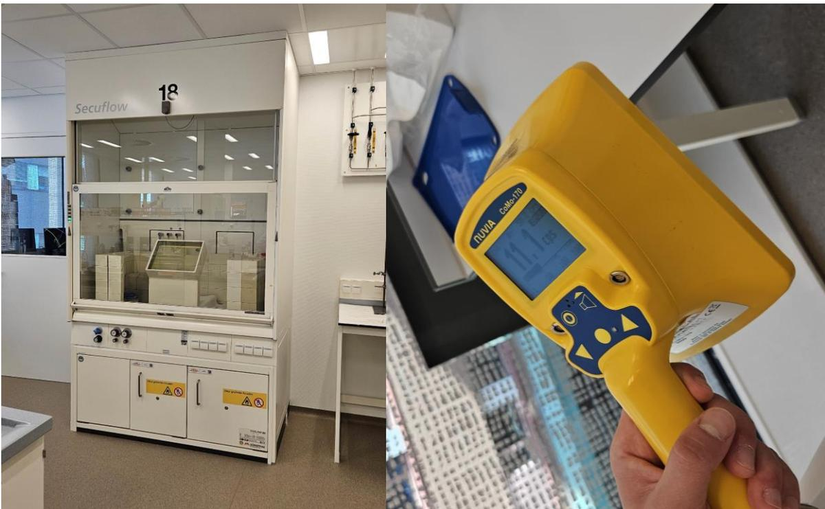
圖 5、實驗操作櫃，裡面已設置好鉛屏蔽，一般標誌實驗皆在裡面進行。實驗前後皆要用偵檢器確認有無污染。
