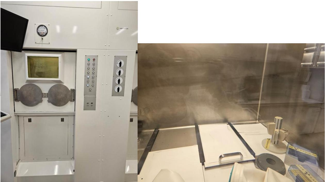
圖 7、熱室(Hot cell)外觀與內部，主要用於操作 45 mci 以上的放射性活度。
