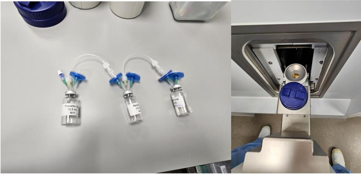
圖 16、左圖為最終過濾示意圖，鉛-89 標誌抗體會經由氦氣控制，自動化進行過濾，經過 2 道傳遞瓶，最後移至成品瓶。右圖為成品瓶，會放置在鉛罐中，移送至醫院進行給藥。
