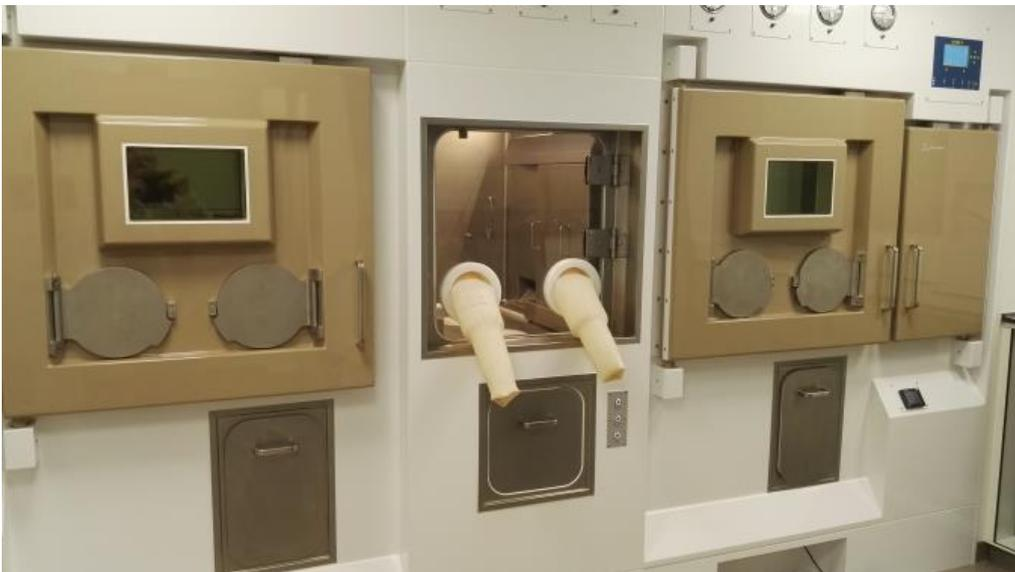
圖 15、最終過濾室，在此進行鉛-89 標誌抗體的最終過濾步驟，所有物品須經由中間手套箱傳遞至兩旁手套箱中。
