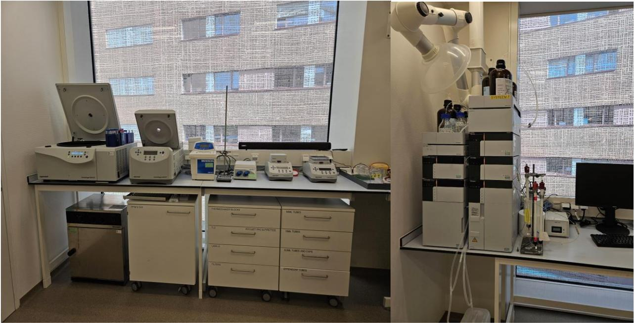
圖 6、左圖為離心機、震盪機與加熱混合器。右圖為品管分析用 HPLC。
