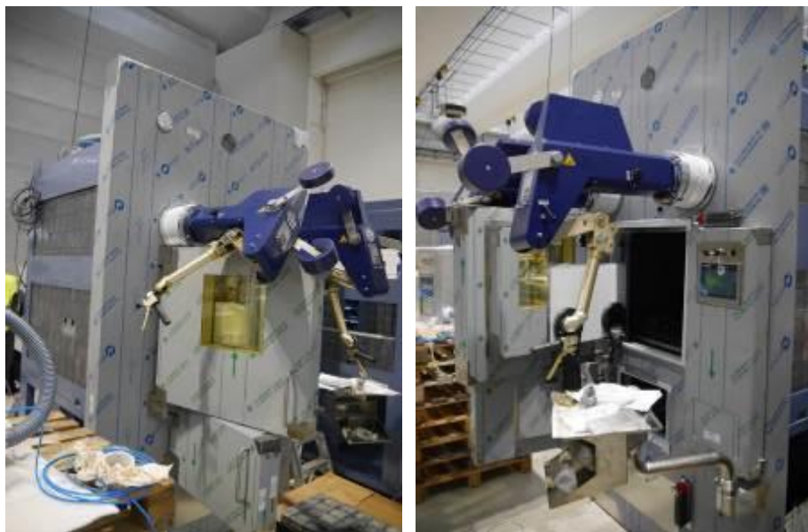
圖七十七、鉛室組裝安裝 HWM 機械手臂及測試部門
