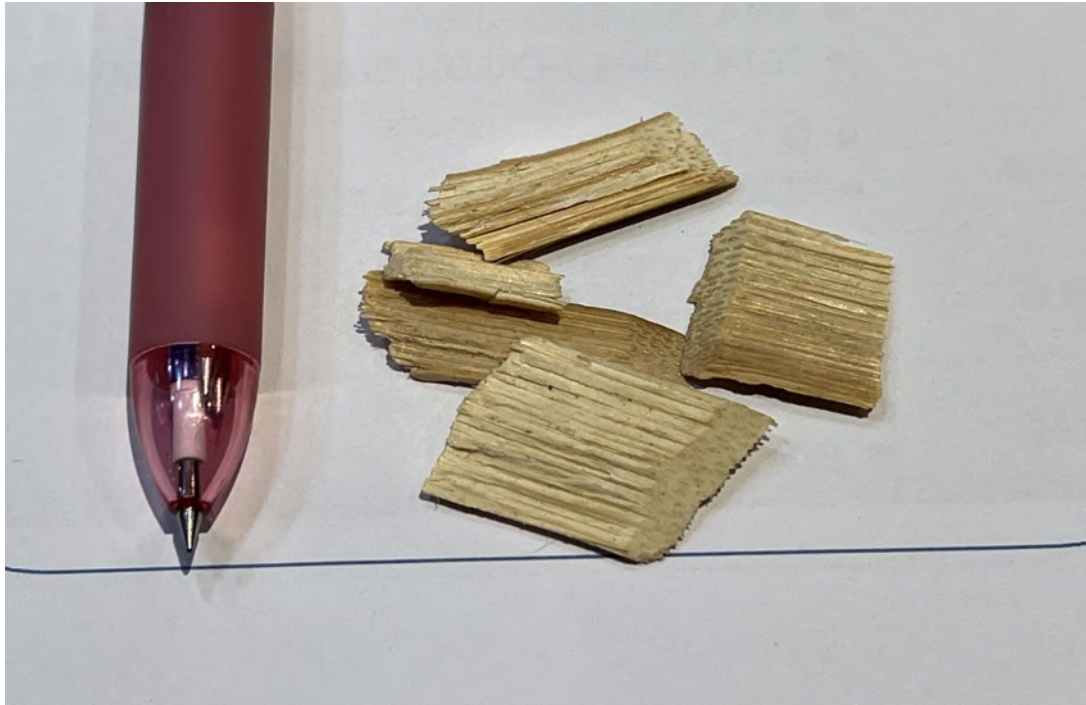
附圖 7、竹子裁碎後的碎竹屑(chips)。(詹為異照片提供)
