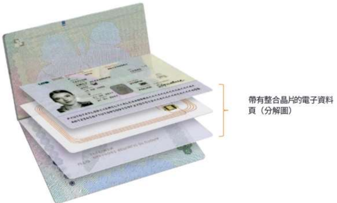
圖 3-1-2 晶片及天線模組與保護載具 (PC 之類硬質塑膠卡) 結合
