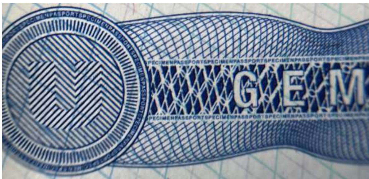
圖 3-1- 19 凹版幾何圖案網紋印刷隱藏圖案，凹版微小字、反白微小字等
