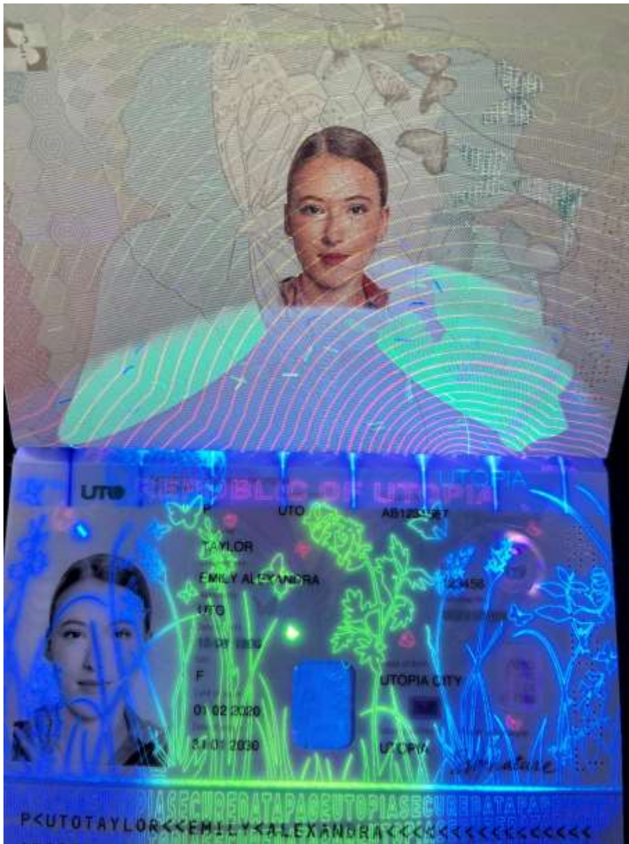
圖 3-1- 15 印刷技術安全防護(多重副影像、顯性、隱性功能油墨等)
