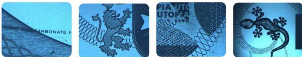
圖 3-1-5 聚碳酸酯 PC 壓花安全功能示意
