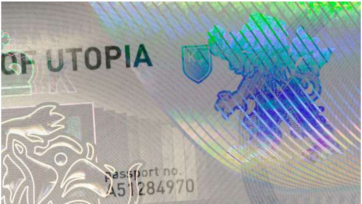
圖 2-1- 25 KINEGRAM HDM 在證照上呈現高解析金屬化細緻線紋的圖像
