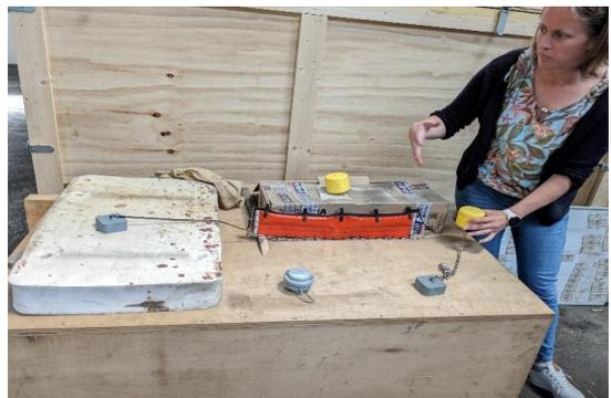
圖 3-41 攔油索和固定浮標運用模型
