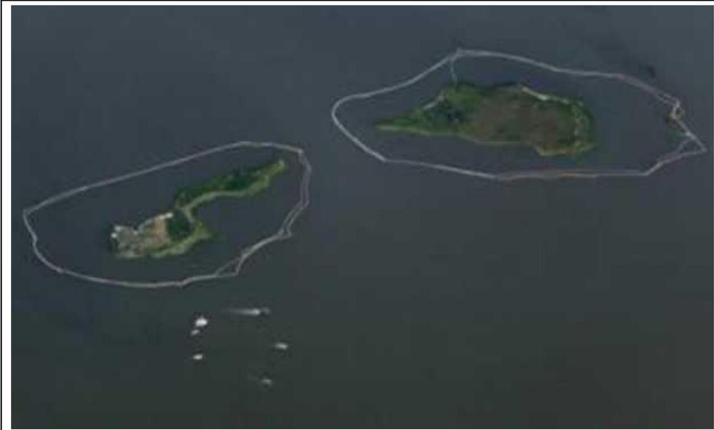
圖 3-9 利用攔油索保護海岸線 Deepwater Horizon (2010)
