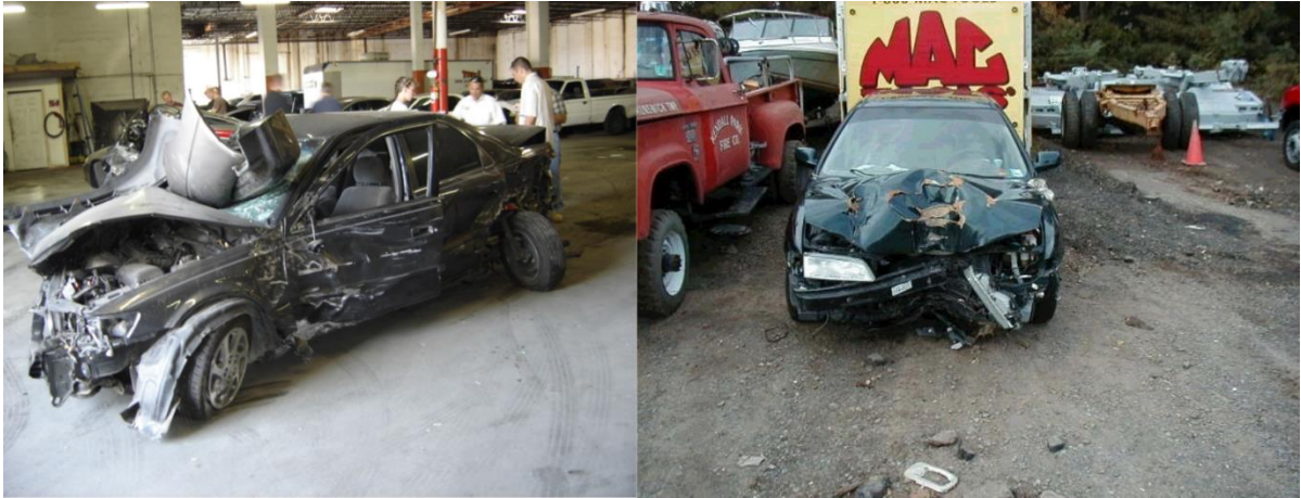
圖2-22 外部接觸性破壞
