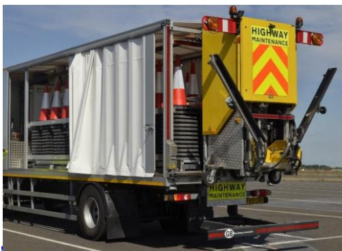
圖 3-26 自動擺放交通錐之工程車
