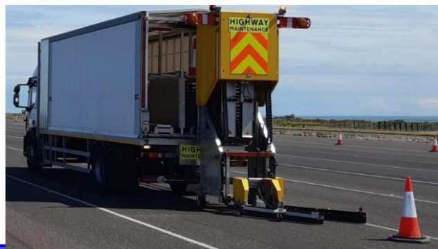
圖 3-26 自動擺放交通錐之工程車
