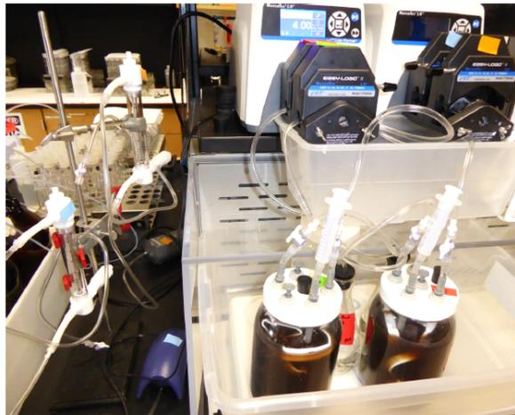
圖 5. 低速率曝氣方式提高 pH
