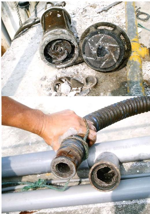
圖 17. 臺灣畜牧廢水場管線與馬達結晶
