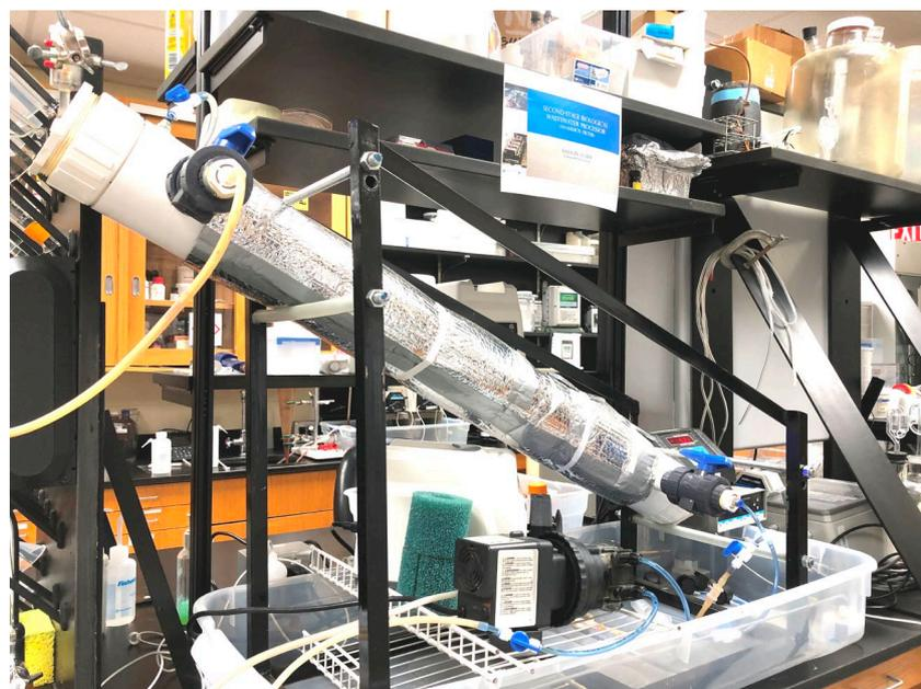
圖 10. 應用 Anammox 於太空中回收尿液中氨的模型管柱
