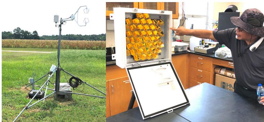
使用 TDLAS 方法測定溫室氣體排放，會搭配 3-D 風速計進行校正（左圖）以雷射方式測定溫室氣體，距離越遠，接收端的 Bin 數量就要更多（右圖）
