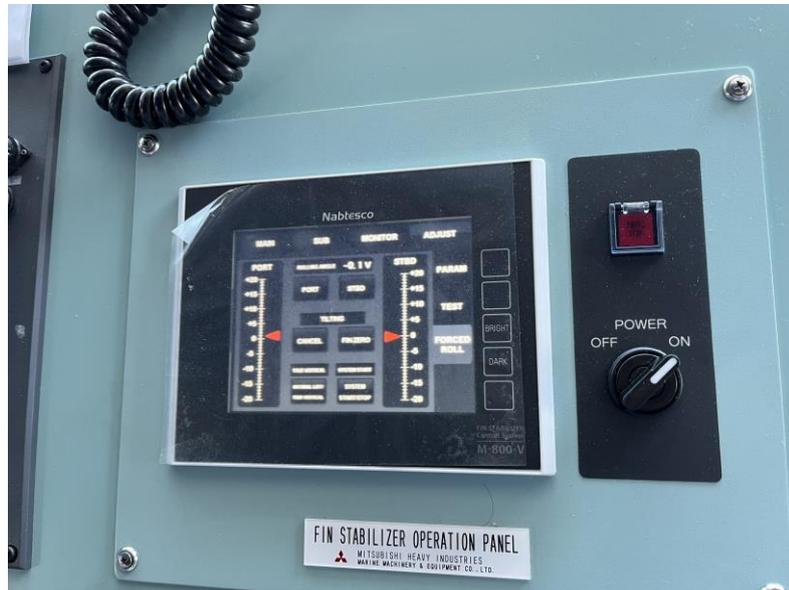
圖 10 穩定翼控制面板
