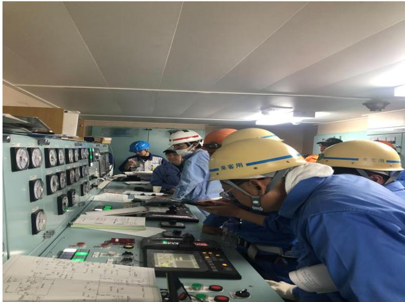
圖 14 機艙控制室施行主機空車轉速測試
