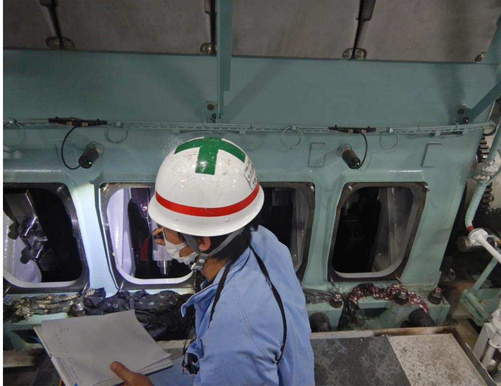
圖 15 曲柄軸撓度測試
