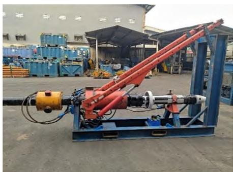
圖十四、Canrig Casing Drive System
