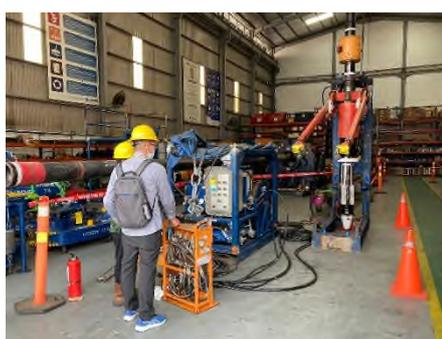
圖十五、CDS 採用液壓控制，操作方式相當簡單。
