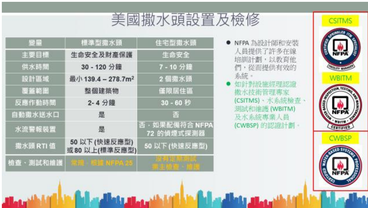
圖 9 美國標準型與住宅型撒水頭設置及檢修比較、NFPA 相關認證訓練說明圖
