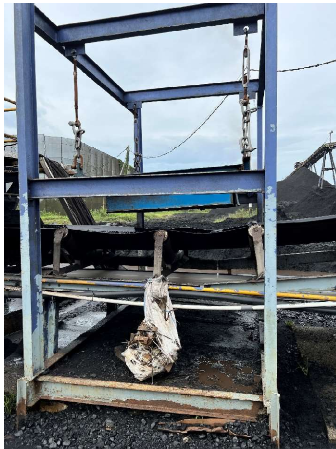
圖 40 皮帶傳輸過程的金屬檢測
