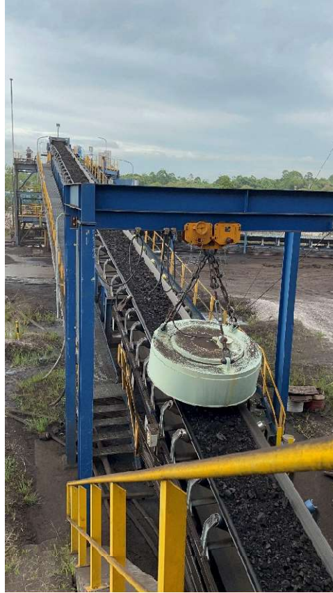
圖 15 傳送過程進行金屬檢測
