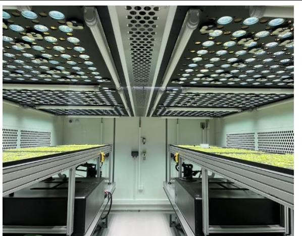
圖 46. 多重照相鏡頭及動態調光系統(上方)人工氣候植物生長室，其 PlantScreen™ 系統可快速掃瞄植株，掌握生育及生理狀態。
