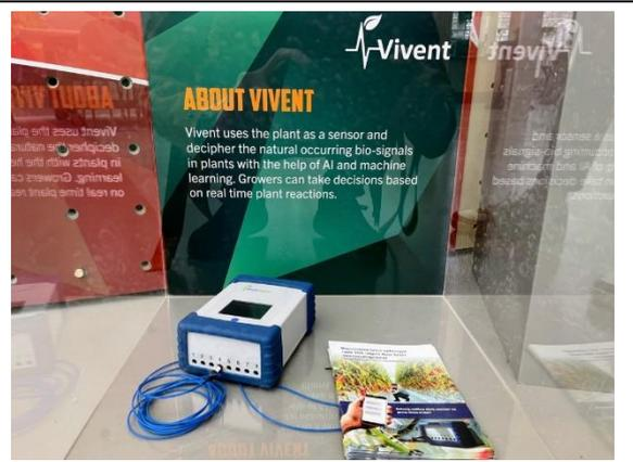
圖 8. World Horti Center 展示的 Vivent 植物電生理訊號感測器。
