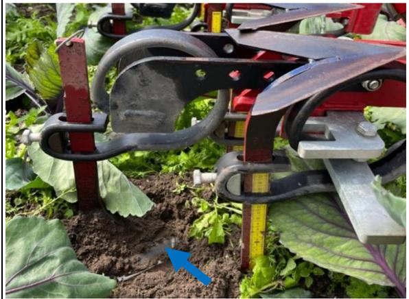
圖 17. 鏟草的農機具刀片，可依畦寬調整間距。
