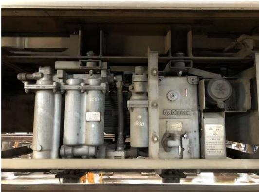
圖 89 TEMU2000 型螺旋式空氣壓縮機
