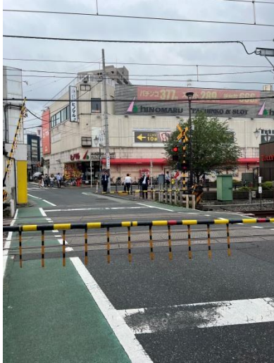
圖 3.5.11 西武鐵道裙襞式遮斷桿
