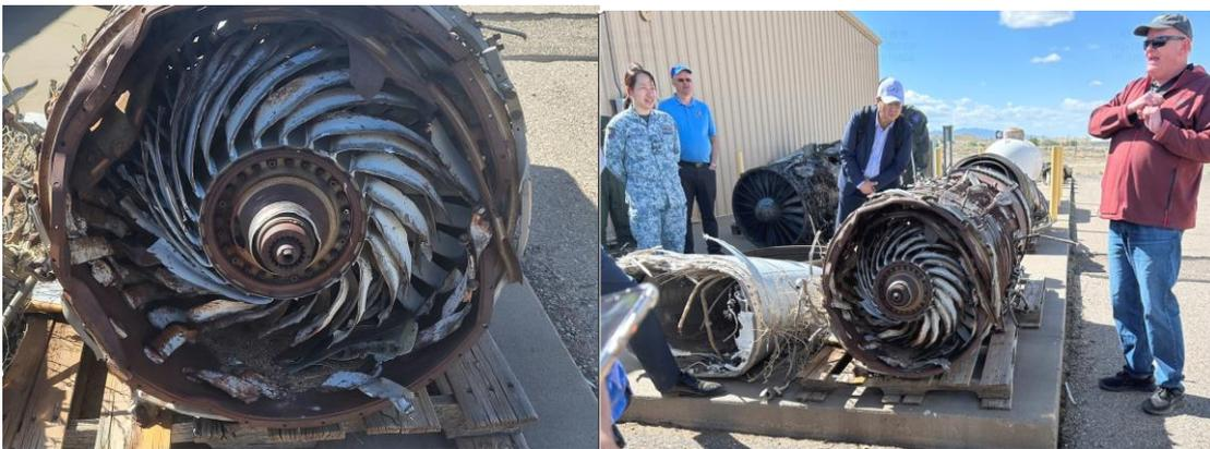
圖11. 講述發動機具動力下撞擊水面之差異
