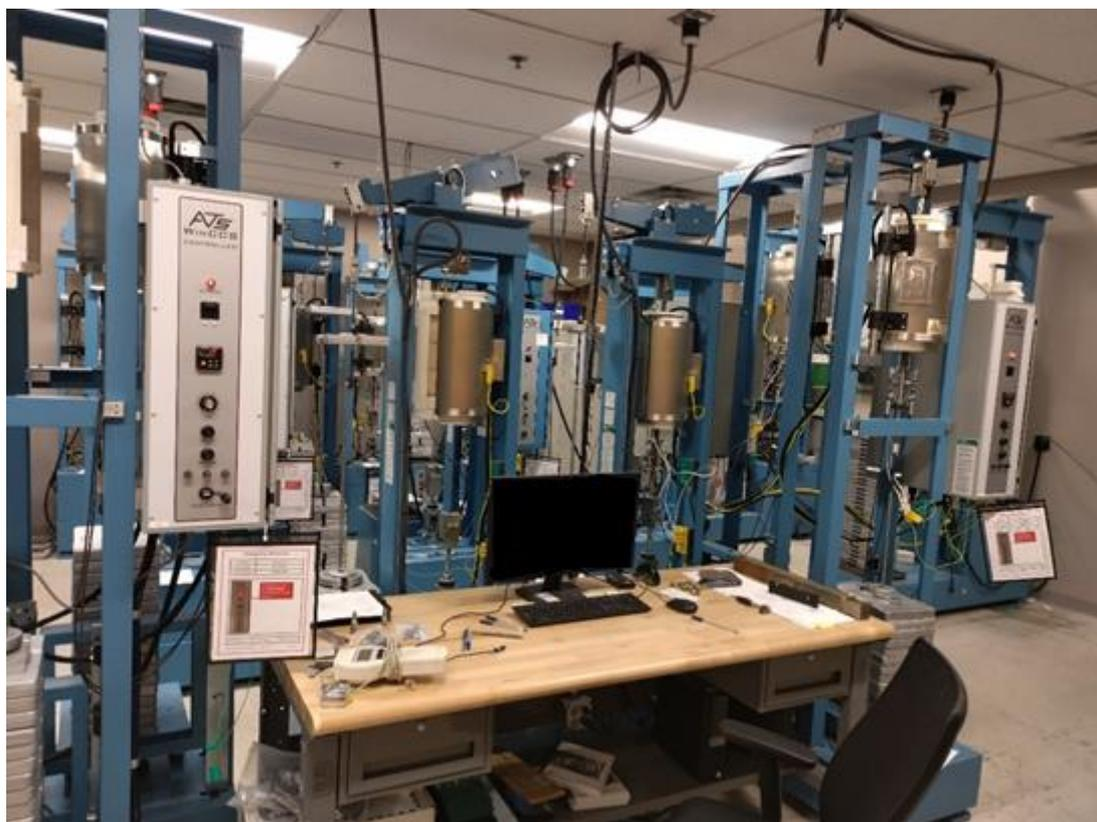
圖 15 多台潛變試驗設備
