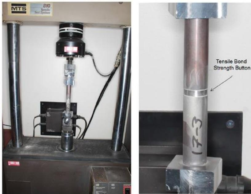
圖 6 塗層結合強度實驗 ASTM C633
