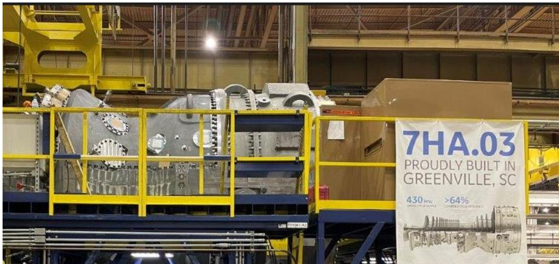
圖 19 正在進行安裝測試的台中電廠 7HA.03 燃氣渦輪機
