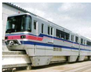
大阪高速鉄道 株式会社殿納 2000系 モノレール車両 Type 2000 Straddle Type Monorail EMU for Osaka Monorail Co., Ltd.
