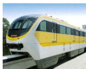
韓国 大邱広域市都市鉄道3号線納 モノレール車両 Straddle Type Monorail EMU for Daegu Urban Railway Line No.3, Korea
