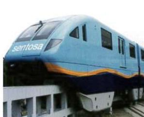
シンガポール セントーサ開発公社殿納 モノレール車両 Straddle Type Monorail EMU for Sentosa Development Corporation, Singapore.
