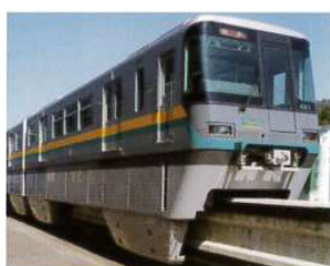
重慶市軌道交通総公司殿納 1000形 モノレール車両 Type 1000 Straddle Type Monorail EMU for Chongqing Rail Transit General Corp.
