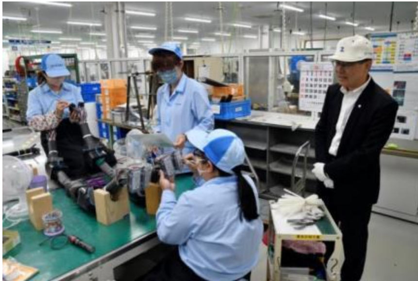
圖 4.4.2-9 本局人員檢驗跳線導通絕緣測試情形
