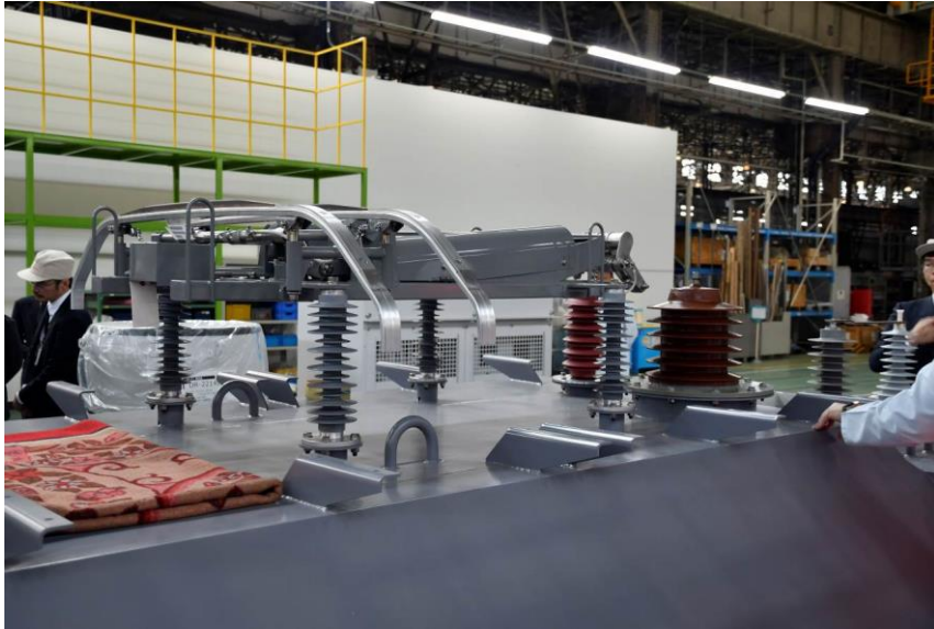
圖 4.5.1-18 集電弓已安裝於車頂部件
