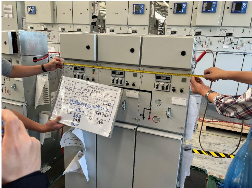
圖 3-4 外觀尺寸量測
