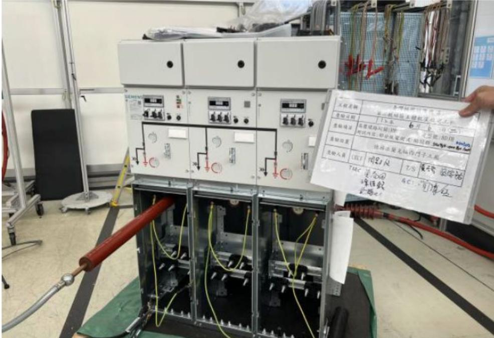
圖 3-14 部分放電測試
