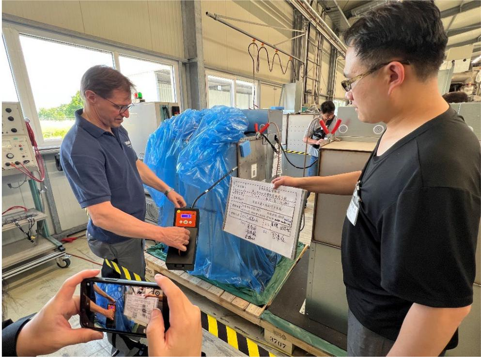
圖 3-15 SF6 氣體洩漏測試
