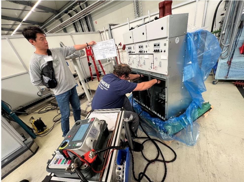
圖 3-10 接觸電阻測試
