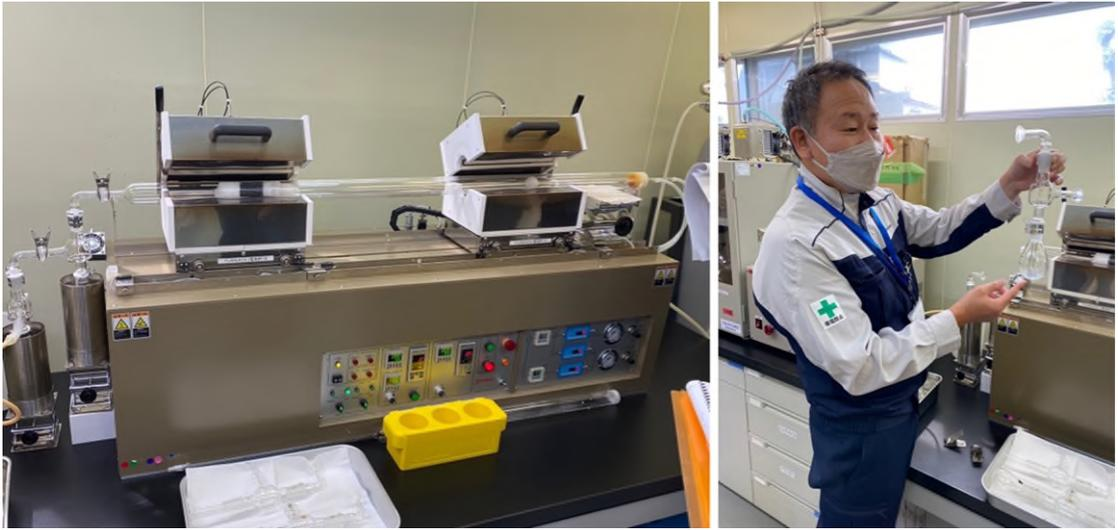
圖 4、KANSO 計測分析所燃燒儀(左圖)與燃燒後的冷凝作業(右圖)
