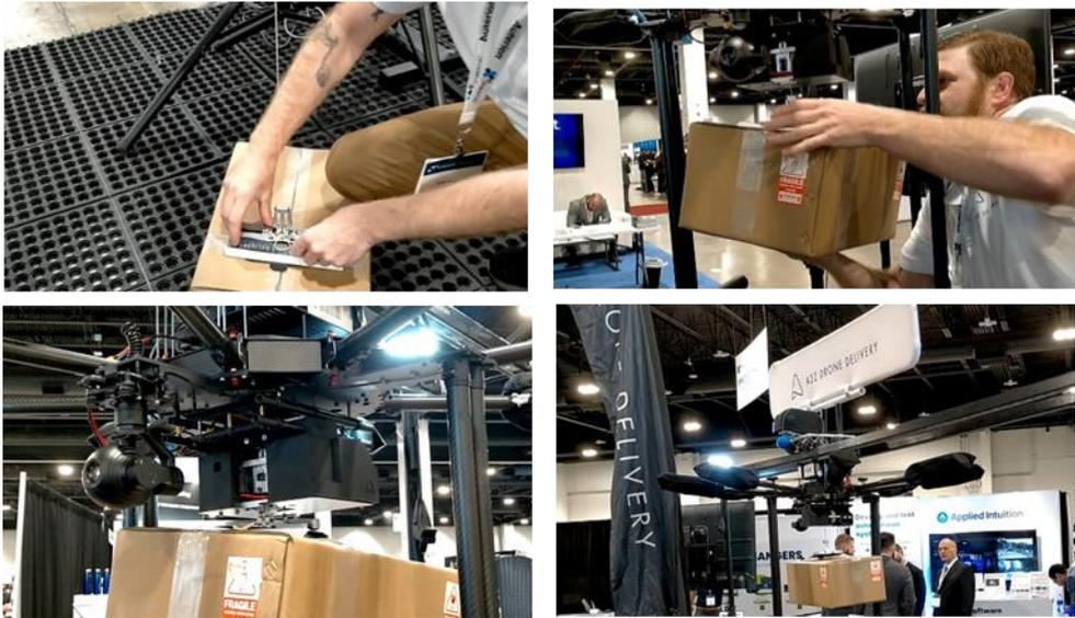
圖 17 自動卸載系統
