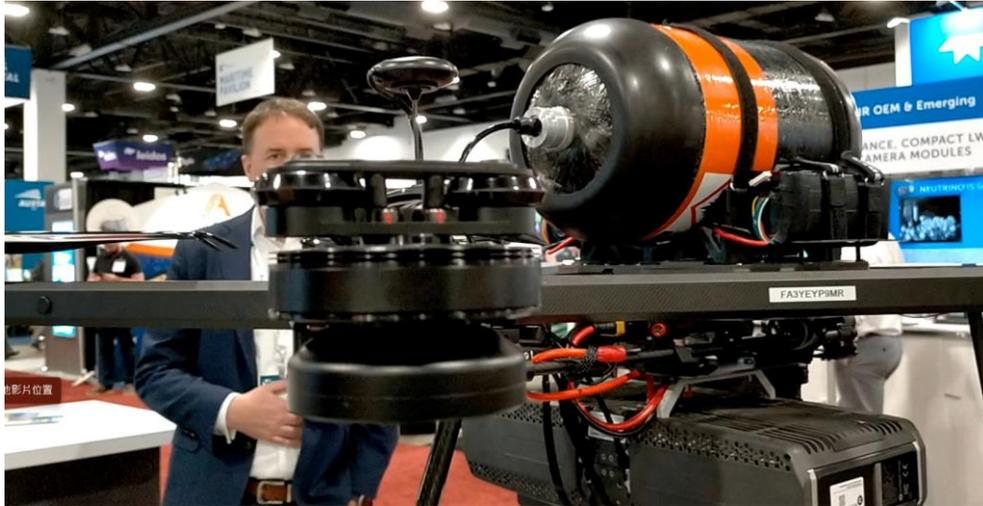
圖 22 Intelligent Energy 展出與 Cyberhawk 合作之氫燃料電池動力無人機
