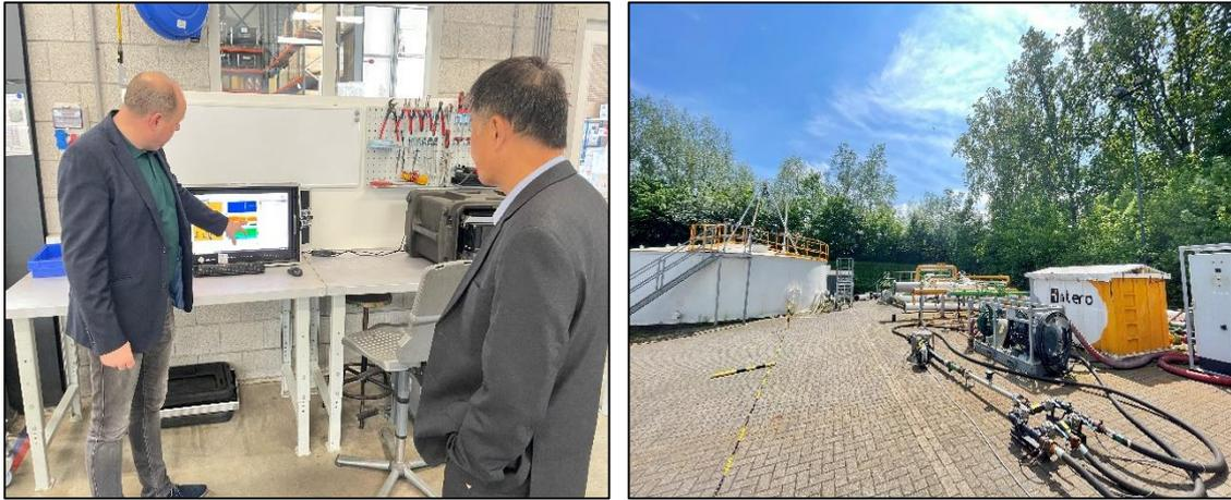
圖十二、UT超音波即時檢測顯像展示及管線模擬驗證測試迴路
