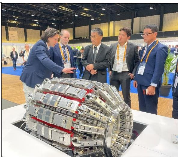
圖二、電磁超音波(EMAT)
