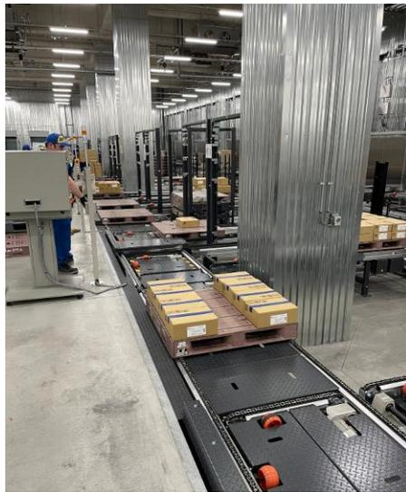
圖 30、冷鏈倉儲中心使用自動化車載設備進行貨物進出倉作業
