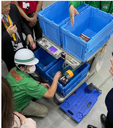
圖 27、零星貨物揀貨作業使用推式揀貨籃車
