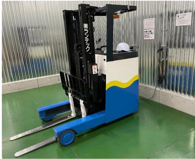
圖 38、採用電動堆高機，避免燃油機械產生熱能及廢氣影響室內恆溫
