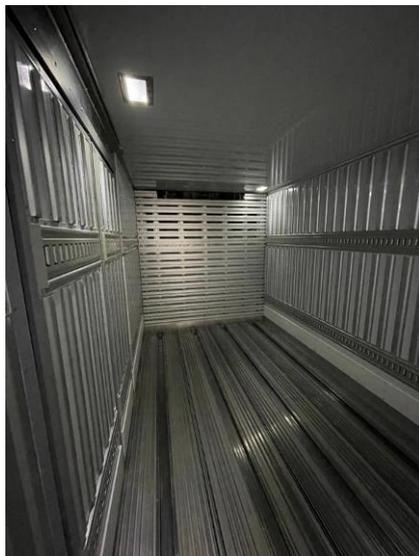
圖 34、貨車車廂配置隔板設備，可分隔成前、後室並設定不同溫度
