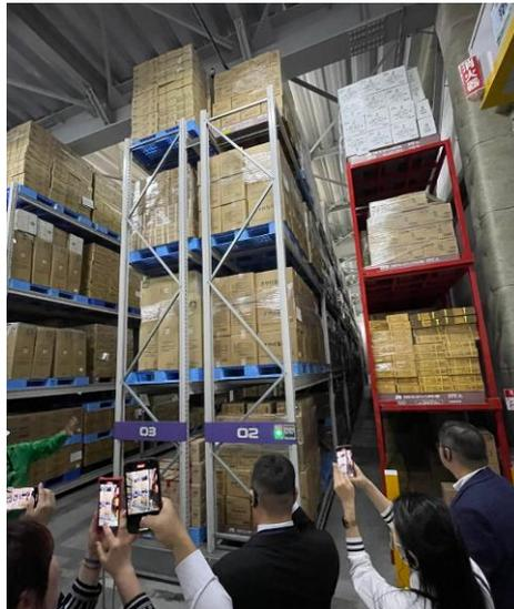
圖 26、移動式料架可配合作業需求進行橫移，增加儲貨量及空間使用率
