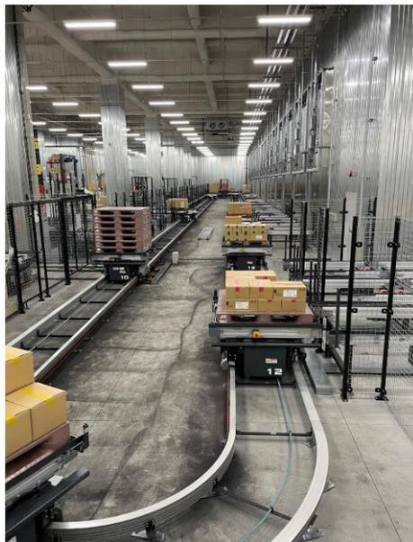
圖 31、冷鏈倉儲中心使用自動化車載設備進行貨物進出倉作業
