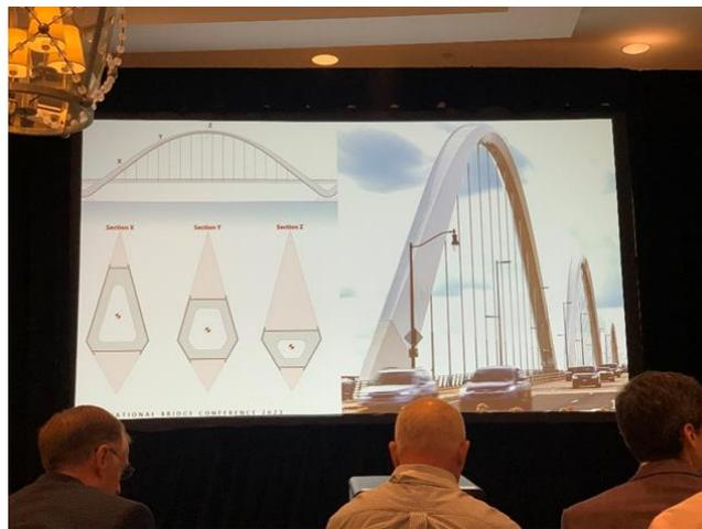
圖 3-12 FDMB 鋼拱門變化斷面截自菱形斷面 (上圖左斷面側所示)
