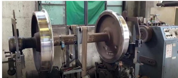
圖 78 潮州基地之動態平衡測試設備
