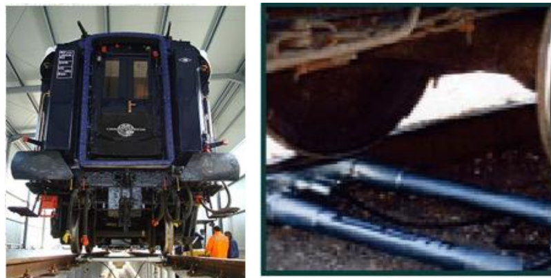
圖 57 靜態軌道車輛獨立輪重秤量設備
