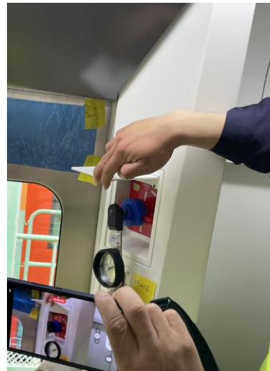
圖 40 量測 EED 操作力
