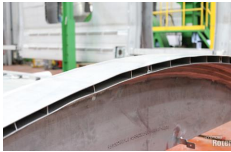
圖 89 鋁材銲接的頂板
