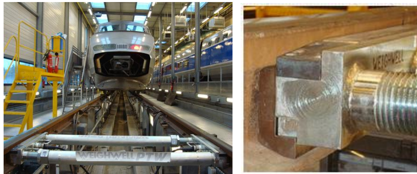
圖 56 可攜式、行進中動態列車秤量設備
