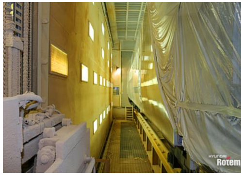
圖 103 完成表面塗層後烘乾作業
