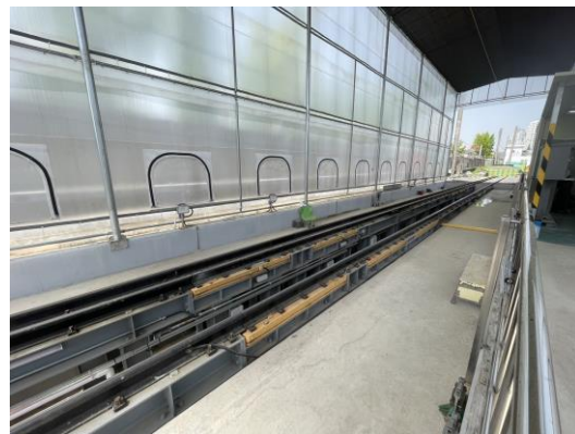
圖 59 車輛輪重秤量設備外觀 圖 60 車輛輪重秤量設備(黃色部分)
