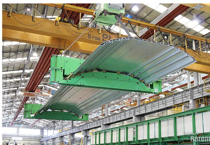
圖 95 以固定式起重機將頂板吊運與車身結合
