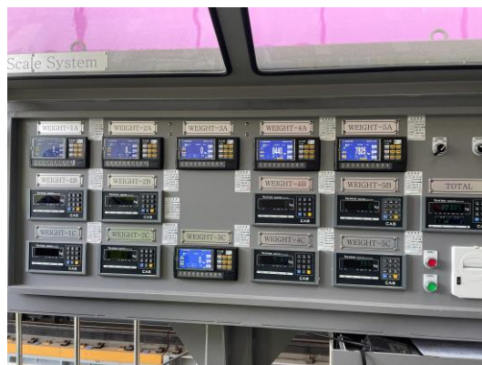
圖 61 車輛輪重秤量設備紀錄儀器(1) 圖 62 車輛輪重秤量設備紀錄儀器(2)
