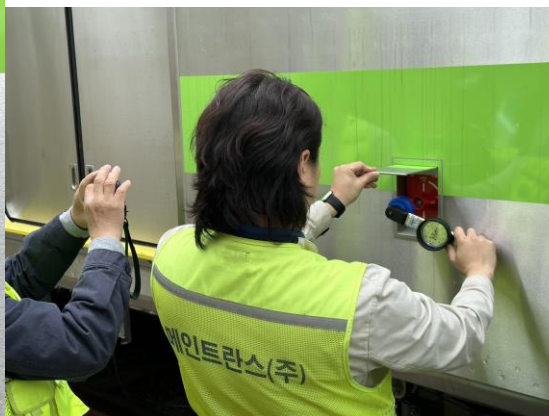
圖 42 量測 EAD 操作力
