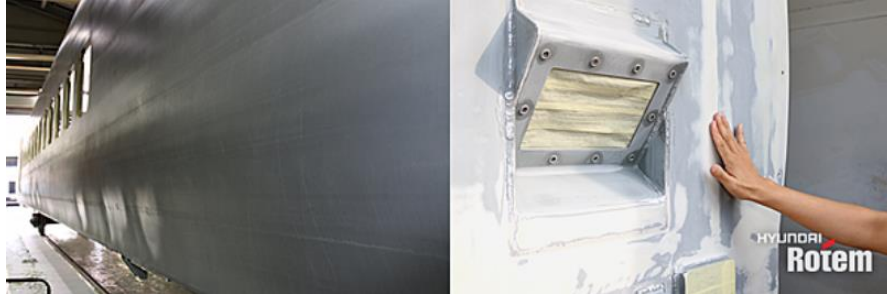
圖 101 補土作業前車身不平整 圖 102 補土作業後平整車身
