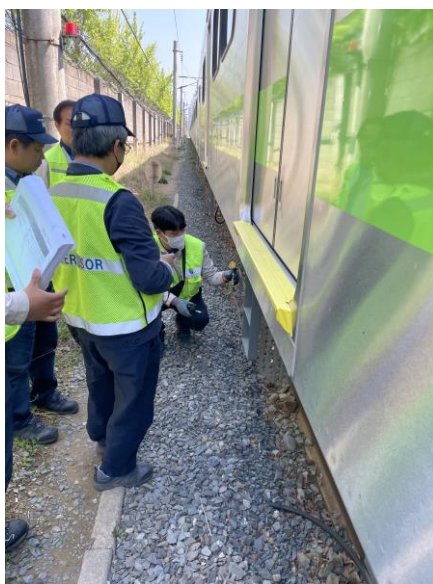
圖 24 量測 Cv 壓力值
