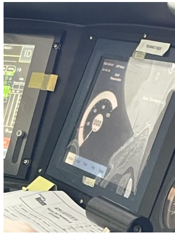
圖 29 開機自動執行軀機測試
