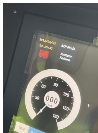
圖 32 MMI 螢幕顯示系統故障
