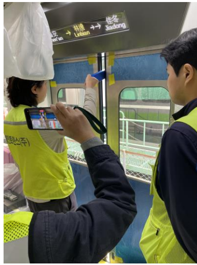
圖 37 車門上部量測障礙物開門作用 圖 38 車門下部量測障礙物開門作用
