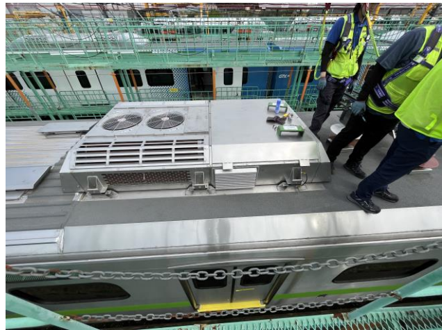
圖 106 車頂防滑塗裝 圖 107 車頂防滑塗層維護人員站立安全(EMU900)
