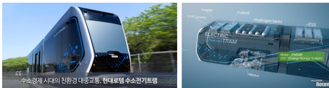
圖 111 現代 Rotem 氫燃料電池和一般電池混合動力路面電車 24
