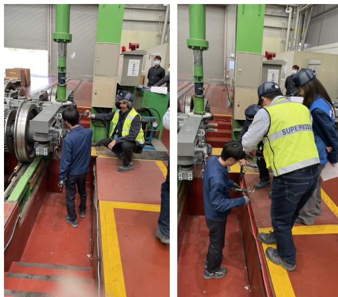
圖 23 量測 W1 載重主懸吊之高度(DP)
