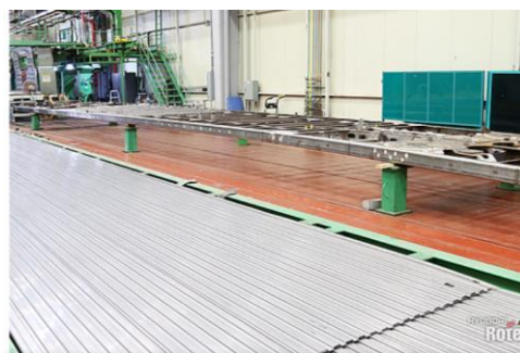
圖 91 銲接而成的底板
