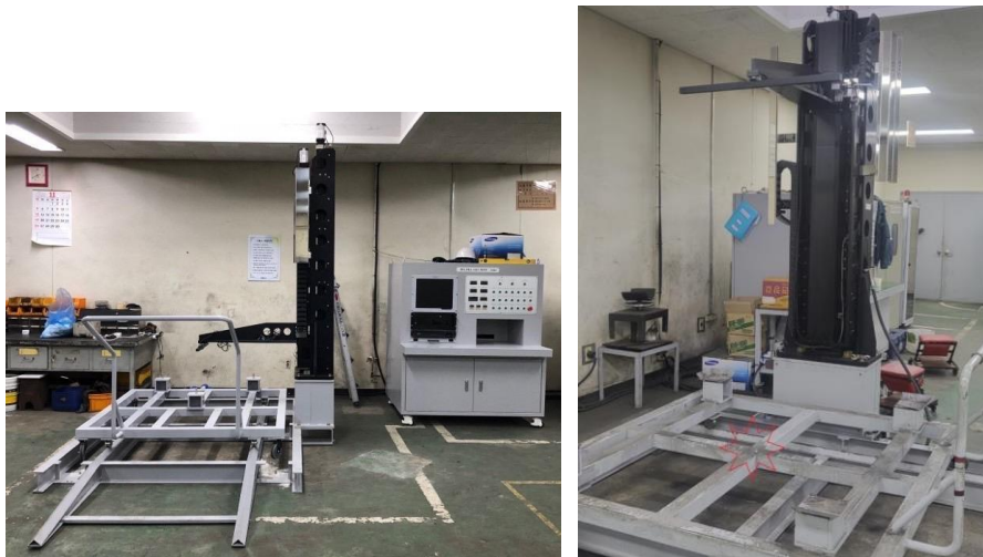
圖 66 國外車輛製造廠集電弓專用測試設備 集電弓測試設備應有:
