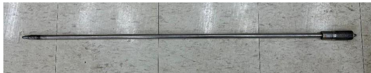
圖 68 輪距測定規(BACK GAUGE)
