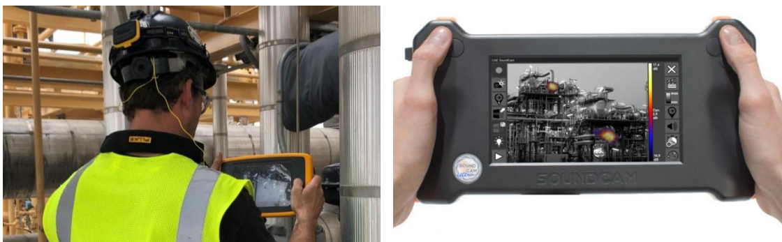
圖 86 聲學成像儀(超音波聲學相機) 13
