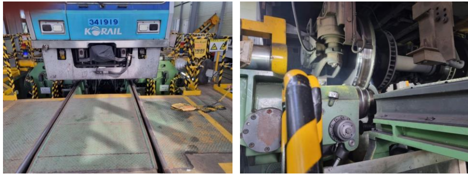
圖 74 韓國國家鐵道工團地下車輪銼削車床設備
