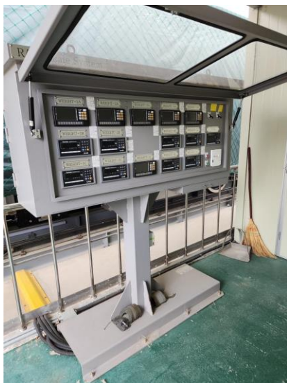
圖 61 車輛輪重秤量設備紀錄儀器(1) 圖 62 車輛輪重秤量設備紀錄儀器(2)
