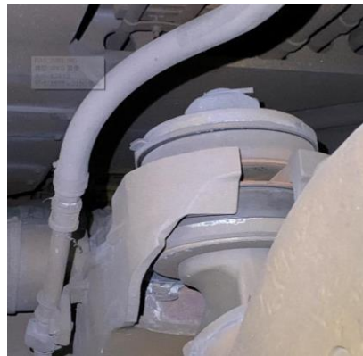
圖 51 齒輪箱吊舉裝置
