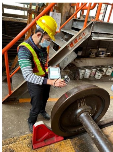
圖 71 光電式雷射量測儀(輪廓量測儀)
