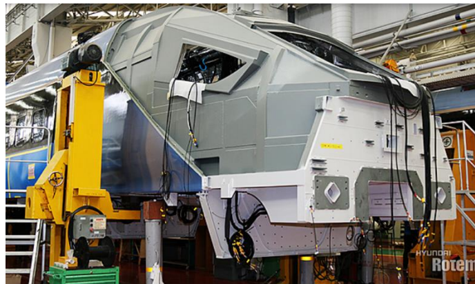
圖 90 前端鋼化塑料結構與車身框架結合
