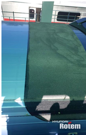
圖 106 車頂防滑塗裝 圖 107 車頂防滑塗層維護人員站立安全(EMU900)
