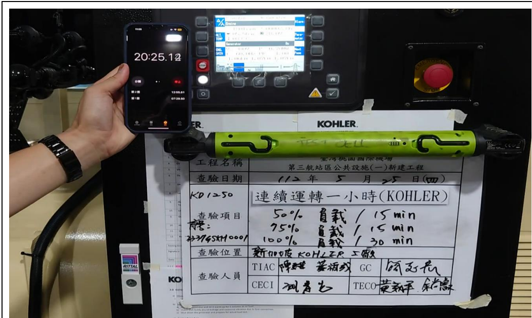
圖 3-23 柴油發電機負載測試 75% (938KW) 15 分鐘
