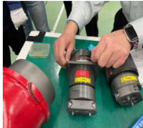
圖 4.2.31 O型環更換作業
