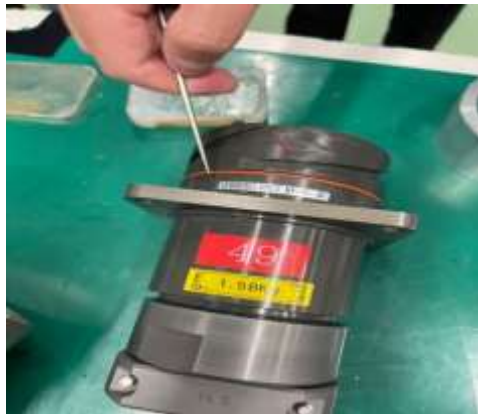
圖 4.2.30 O型環更換作業
