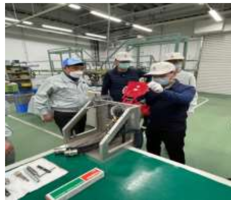
圖 4.2.17 85 芯跳線拆、裝作業
