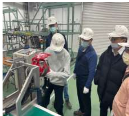
圖 4.2.19 85 芯跳線拆、裝作業
