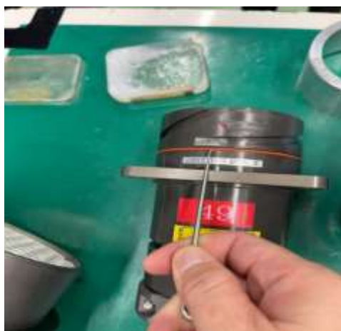
圖 4.2.32 O型環更換作業
