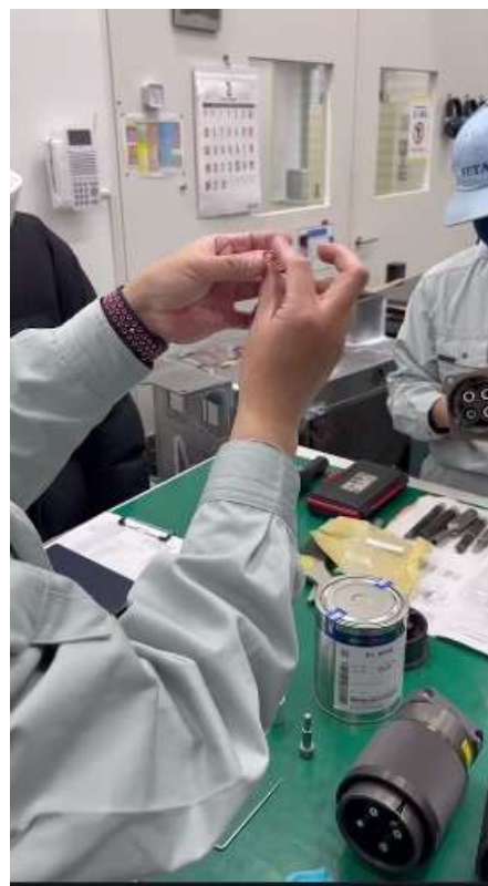
圖 4.2.35 PIN 孔彈簧檢查
