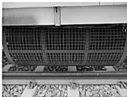
図8. インドデリー地下鉄RS13向け1年走行後の冷却器の状況
