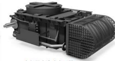
走行風自冷式変圧器
