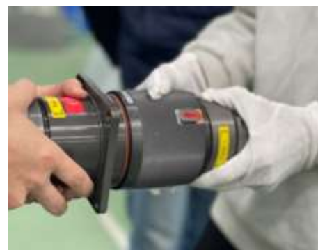
圖 4.2.25 4 芯跳線拆、裝作業
