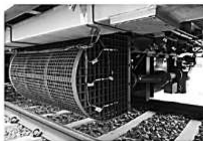
図7. 現車走行試験での油温度測定
