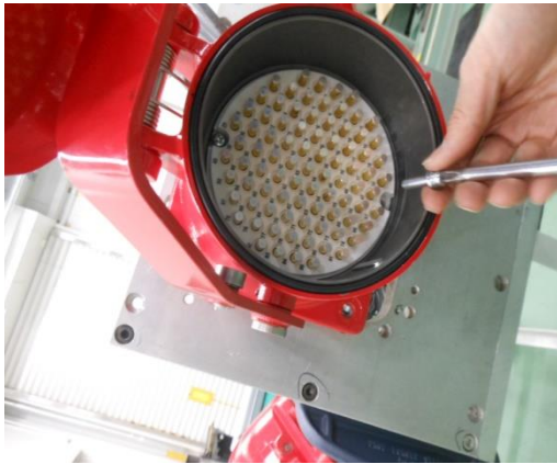
圖 1-15 跳線端子拆解維修說明
