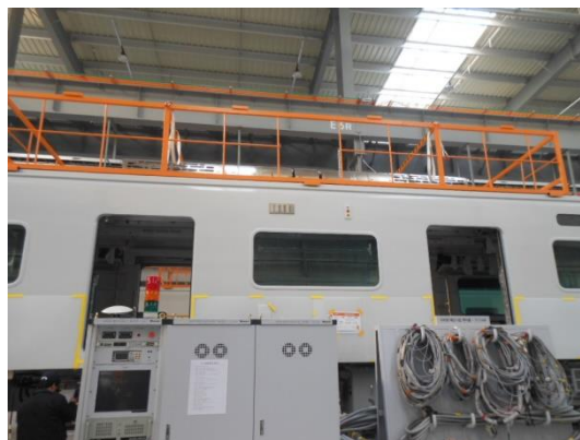
圖 3-6 宇進產電車頂安全移動護欄
