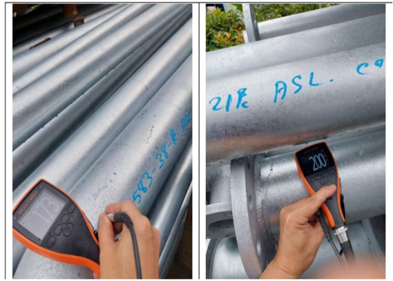
監工週報3/24日檢測鍍鋅管膜厚
