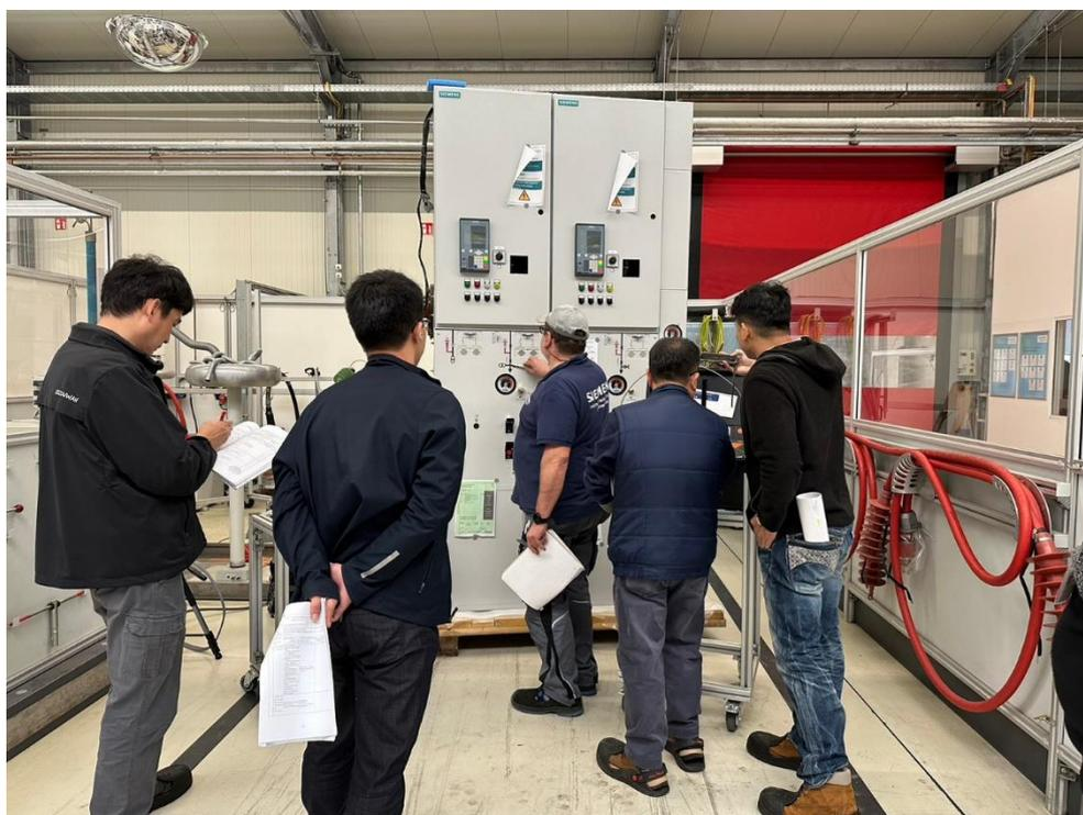
圖 3- 13 控制迴路耐壓試驗
