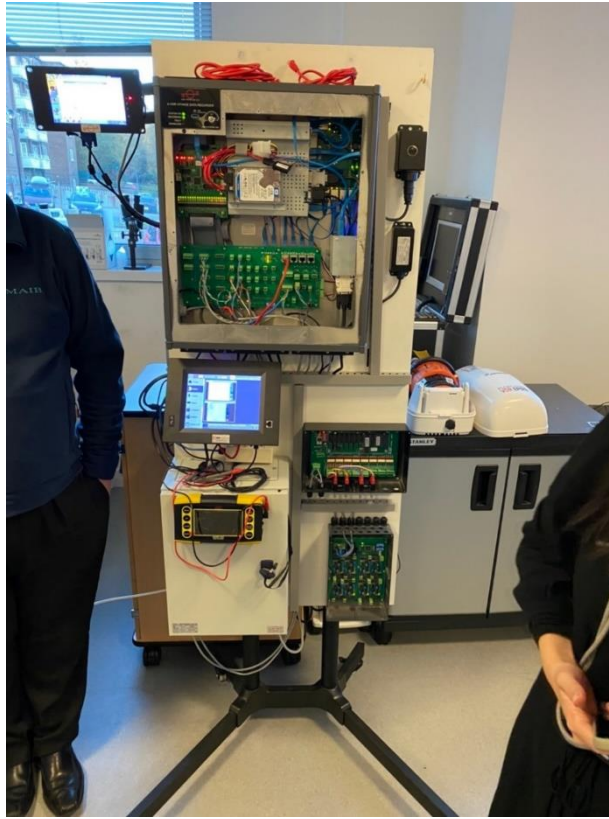
圖 6.3 MAIB 工程技術實驗室訓練用 VDR 主機
