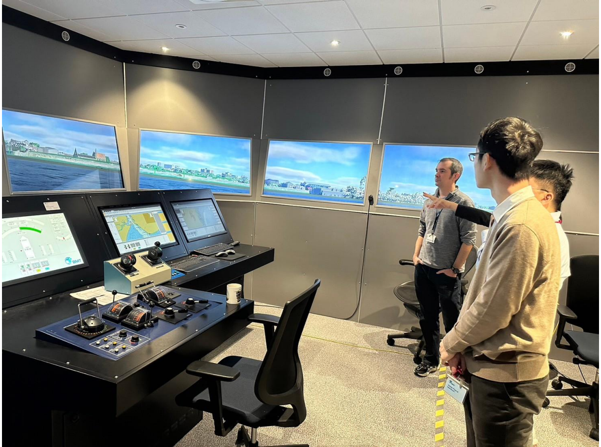
圖 5.2 BMT 公司操船模擬室，透過螢幕串聯模擬極具臨場感
