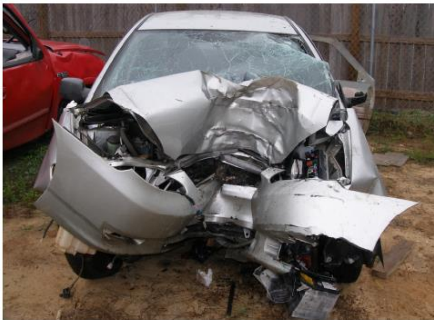
圖 3-23 外部接觸性損壞
