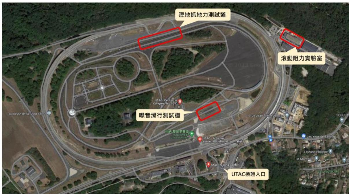
圖 3、利納－蒙萊里測試中心輪胎驗證能量配置圖
