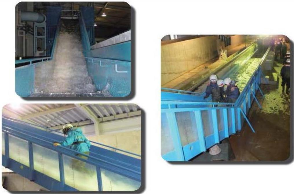
圖 84 洪水流入地下室時的避難疏散模擬設備
